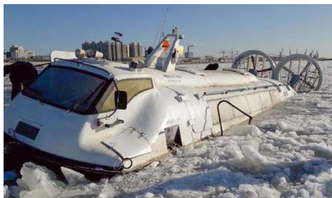
Рис. 5. Авария амфибного судна на воздушной подушке проекта 15060 «Ирбис-1», имеющего в конструкции большое количество элементов из композитов, на Амуре
