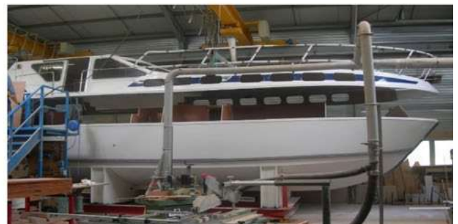
Рисунок 16. Основные конструктивно-технологические решения, применяемые при постройке прогулочных судов коммерческого назначения типа Тагроп. Формование корпуса и установка в него переборок и выгородок (слева сверху); Подготовка к установке секции палубы (справа сверху); Секция палубы после извлечения из оснастки (слева снизу); Установка секции палубы с насыщением на корпус (справа снизу).
