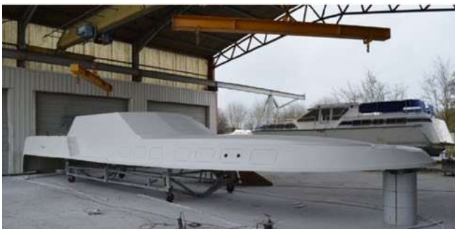
Рисунок 16. Основные конструктивно-технологические решения, применяемые при постройке прогулочных судов коммерческого назначения типа Тагроп. Формование корпуса и установка в него переборок и выгородок (слева сверху); Подготовка к установке секции палубы (справа сверху); Секция палубы после извлечения из оснастки (слева снизу); Установка секции палубы с насыщением на корпус (справа снизу).
