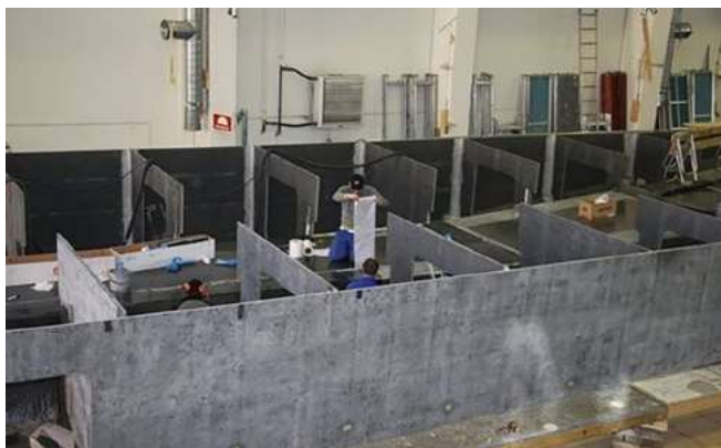
Рис. 2. Формирование надстройки скоростного катамарана из трехслойных панелей из композитов
