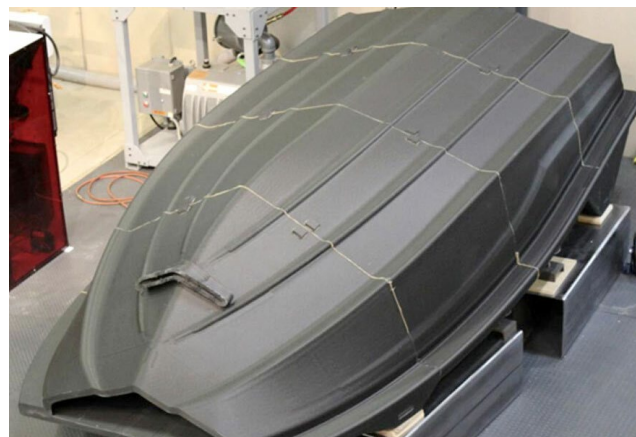
Рисунок 3. Готовая оснастка корпуса катера без носовой секции
