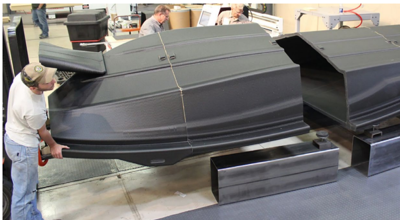
Рисунок 2. Стыковка и склеивание готовых секций оснастки катера, изготовленных с помощью 3D-печати
