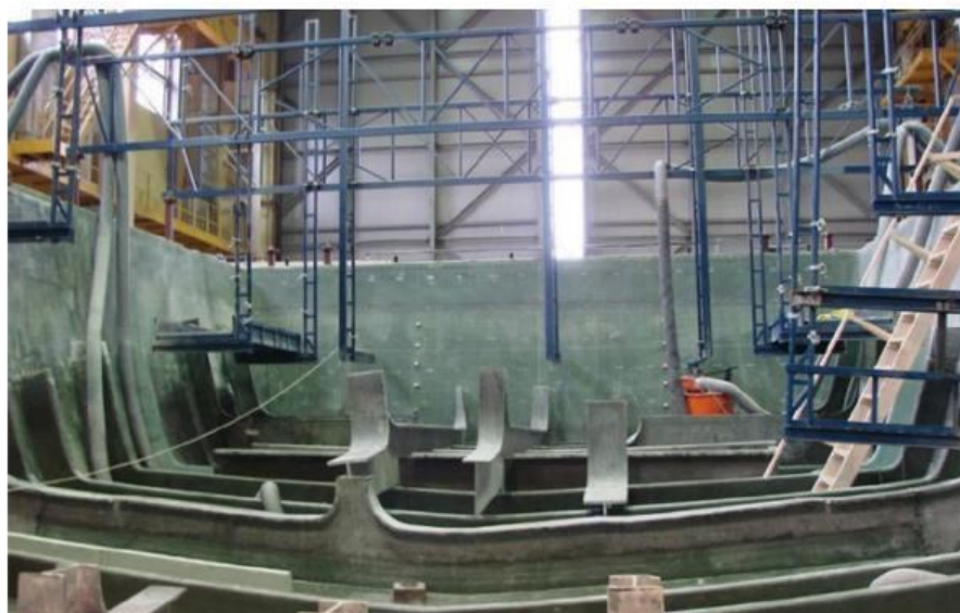
Рисунок 8. Формование корпуса противоминного корабля из композиционных материалов на Средне-Невском судостроительном заводе
