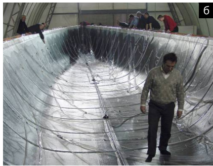
Рис. 1. Принципиальная схема и этапы изготовления корпуса судна методом вакуумной инфузии: а — подготовительный этап, б — пропитка подготовленного пакета.
