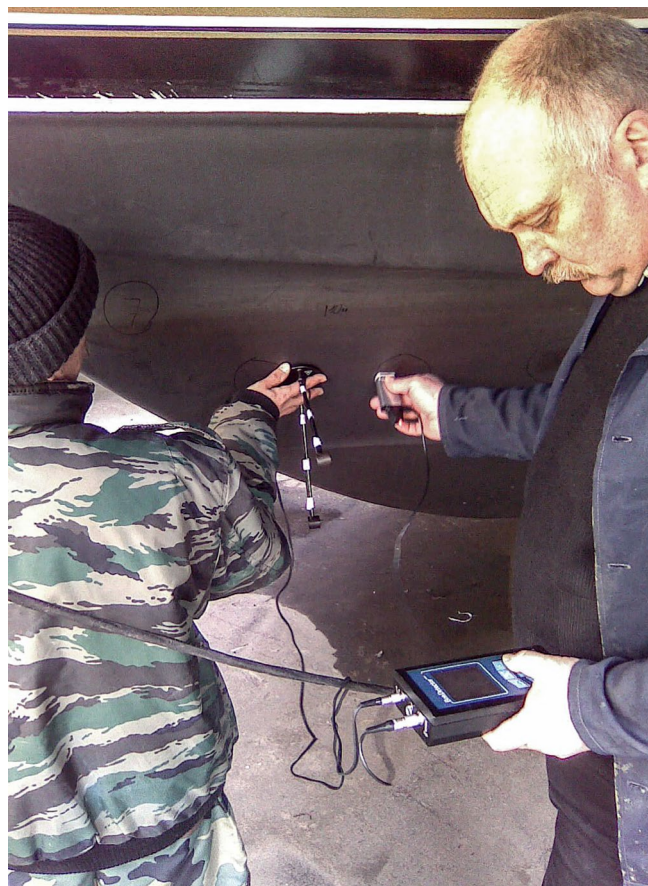
Рис. 6. Исследование корпуса судна из композиционных материалов методами неразрушающего контроля.
