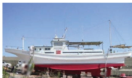
Рис. 5. Японская рыболовная шхуна из композитов на слипе
