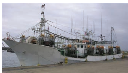
Рис. 1. Японская рыболовная шхуна из композитных материалов, оснащенная приспособлениями для ярусного лова
