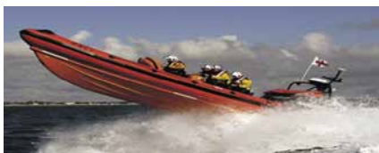
Рис. 1. Легкий спасательный катер из композиционных материалов
