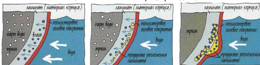
Рис. 11. Последовательность возникновения дефектов водопоглощения
