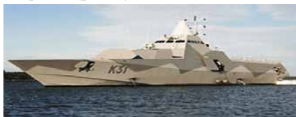
Рис. 6. Шведский корвет, корпус которого выполнен из композиционных материалов
