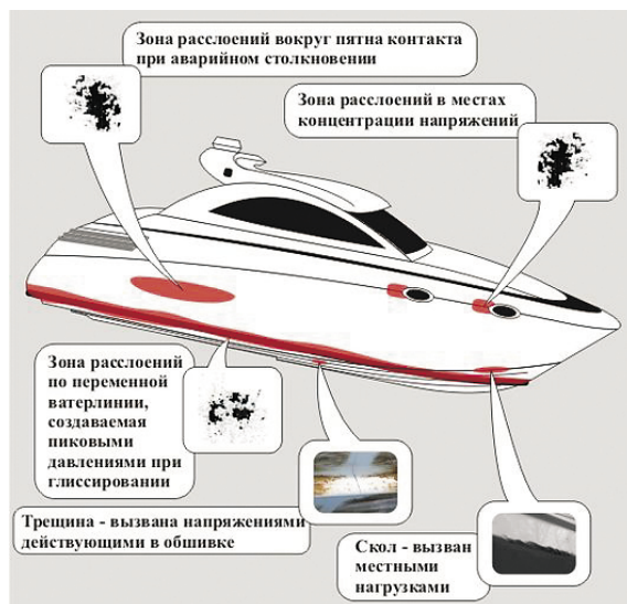
Рис. 13. Обобщенная схема расположения эксплуатационных дефектов на корпусе судна
