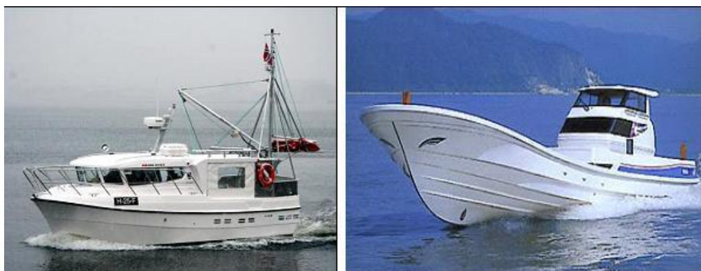
Рис. 1. Промысловые скоростные суда из композитов производства Японии (справа) и Норвегии (слева)
