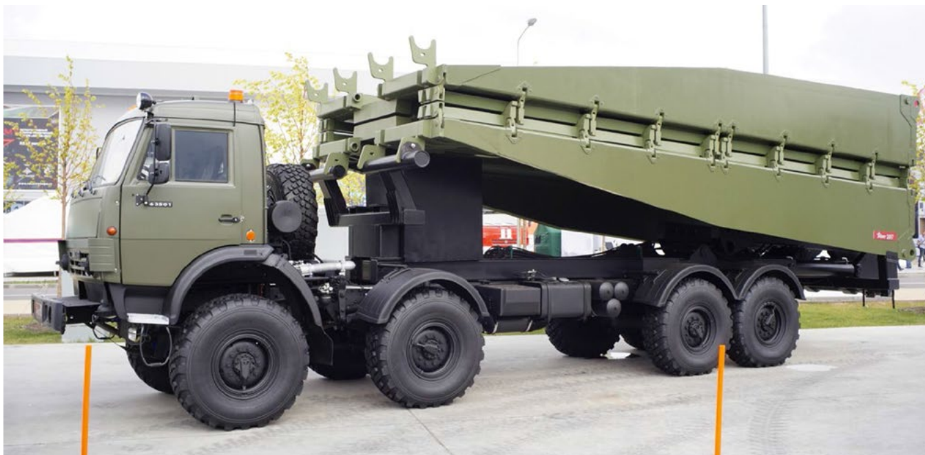
Рисунок 7. Опытный образец мобильного композитного моста ТММ-7.
