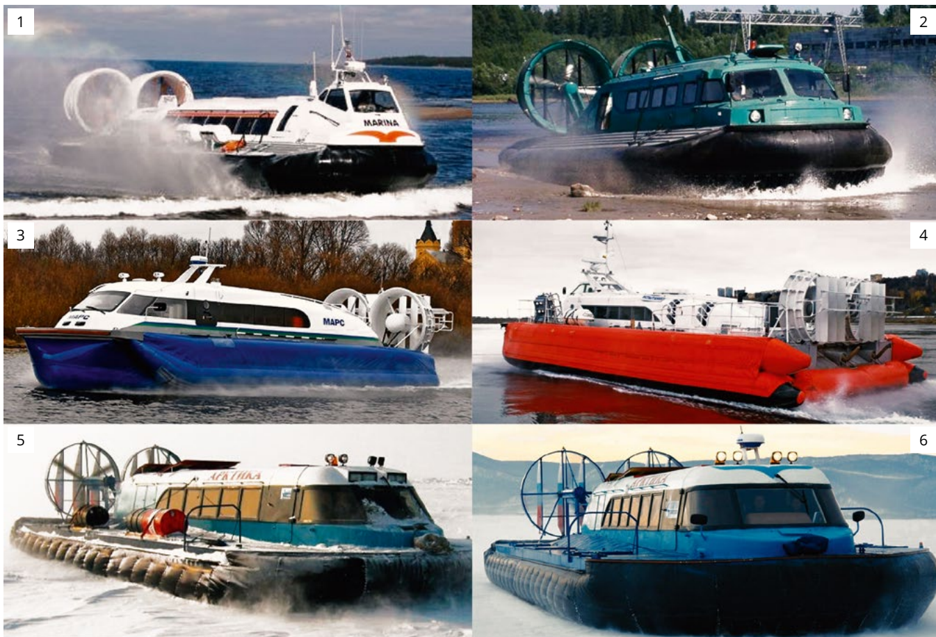
Рисунок 1. Амфибийные суда на воздушной подушке, имеющие корпус из легких сплавов и надстройку из композитов: 1 — АСВП «Ирбис», 2 — «Пума», 3 — МАРС 2000, 4 — МАРС 3000, 5 — АРКТИКА 4, 6 — АРКТИКА 4Д
