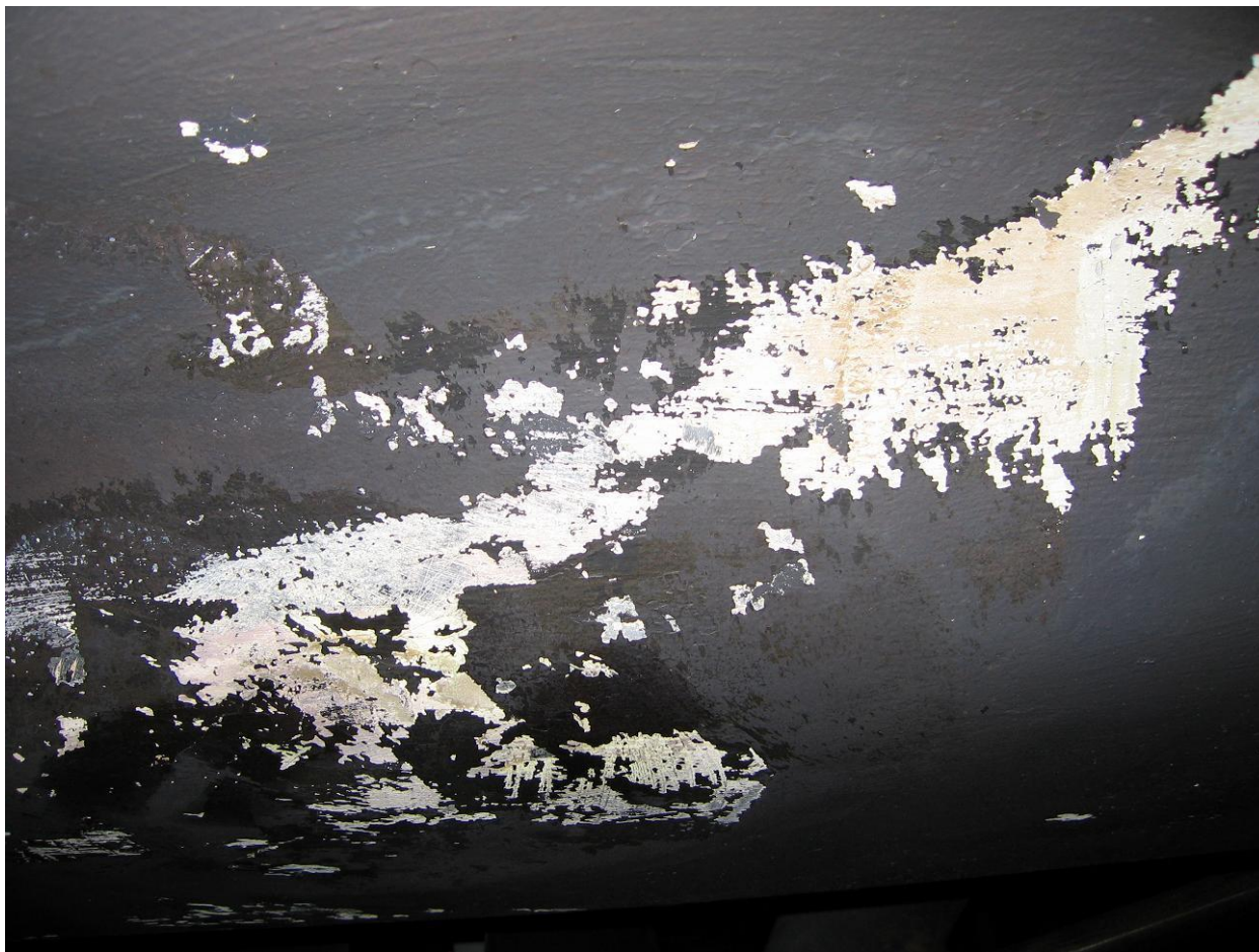
Рис. 1. Осмотические изменения наружной поверхности корпуса судна из композитов
