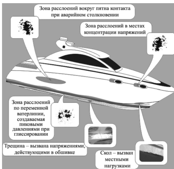
Рис. 5. Расположение дефектов эксплуатационной природы на корпусе судна из композиционных материалов
