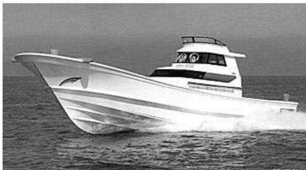
Рис. 1. Общий вид японского промыслового судна из композитов современного типа (обводы типа «глубокое V»)
