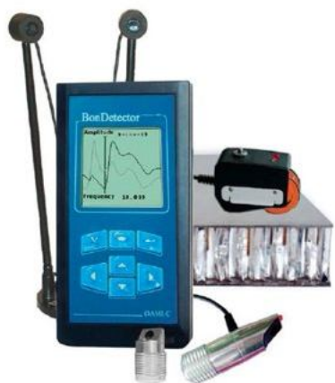
Рисунок 4. Дефектоскоп ДАМИ-С и исследование надстройки СПК из композитов методами неразрушающего контроля.
