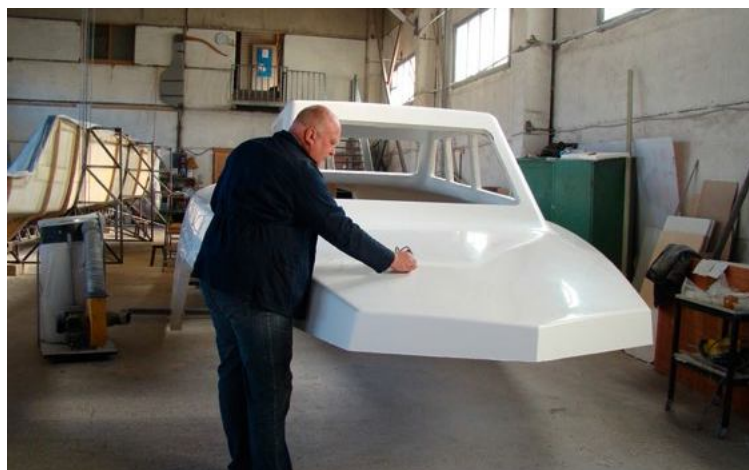
Рисунок 4. Дефектоскоп ДАМИ-С и исследование надстройки СПК из композитов методами неразрушающего контроля.
