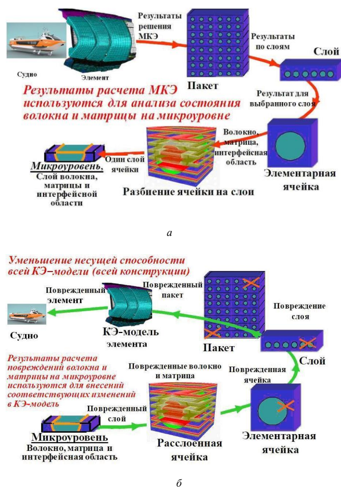
Рис. 2. Последовательности декомпозиции (а) и оценки влияния внутреннего дефекта (б) при определении прочностных свойств композитного крупногабаритного элемента судна
