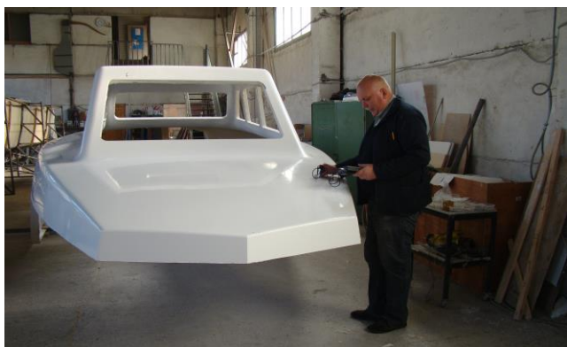
Рис. 5. Опытный образец композитной надстройки СПК
