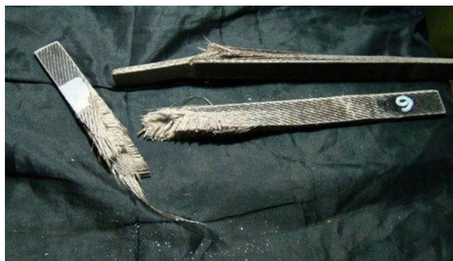
Рисунок 2. Образец базальтопластика на базе ткани БТ11П-ГВС9. Разрушение в процессе испытаний на растяжение
