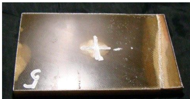
Рисунок 3. Образец стеклопластика на базе ткани Т11-ГВС9 № 5. Расслоение в результате испытаний на удар и последующее разрушение в процессе испытаний на сжатие
