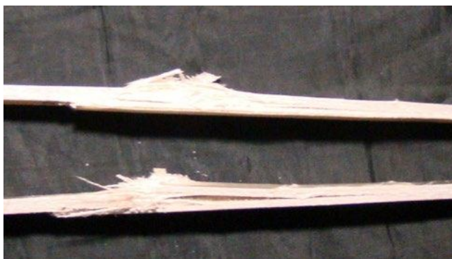
Рисунок 1. Образец стеклопластика на базе ткани Т11-ГВС9. Разрушение в процессе испытаний на растяжение
