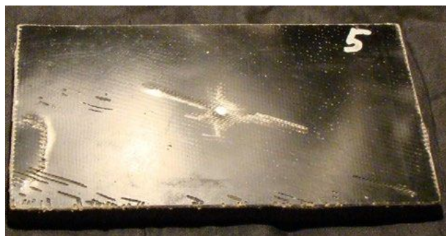
Рисунок 4. Образец базальтопластика на базе ткани БТ11П-ГВС9 № 5. Расслоение в результате испытаний на удар и последующее разрушение в процессе испытаний на сжатие
