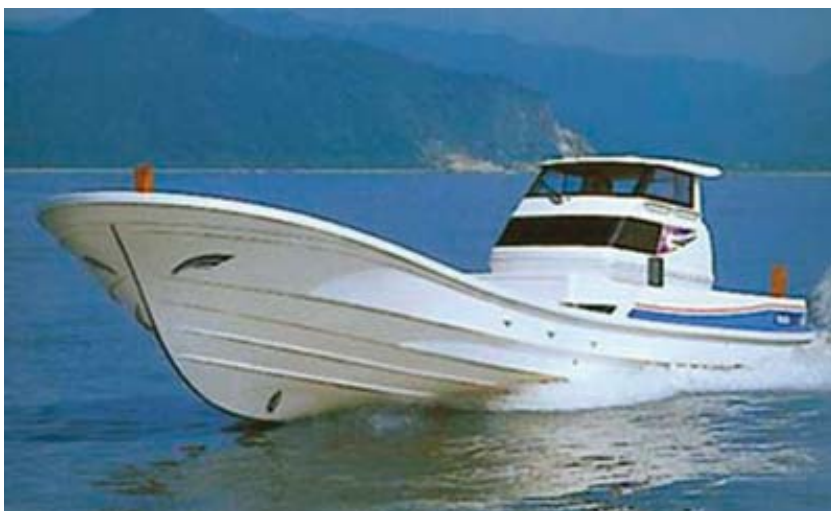
Рис. 1. Промысловое судно с корпусом и верхними строениями из композиционных материалов
