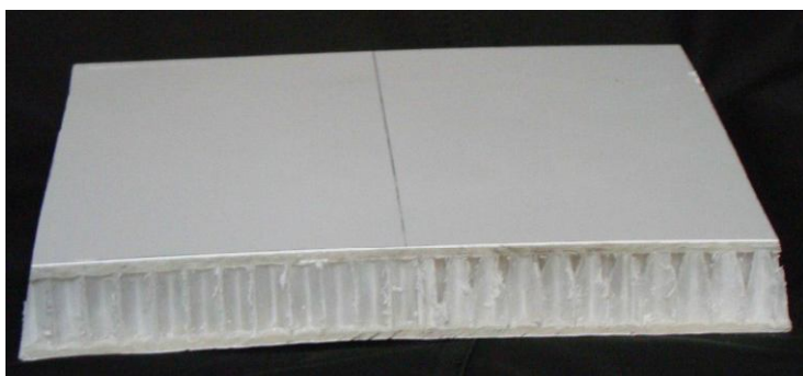
Рис. 6. Элемент конструкции надстройки с легким армированным средним слоем на базе заполнителя pidaplast
