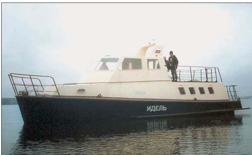
Рис. 2. Катер пр. 82340 с многослойной оболочковой надстройкой
