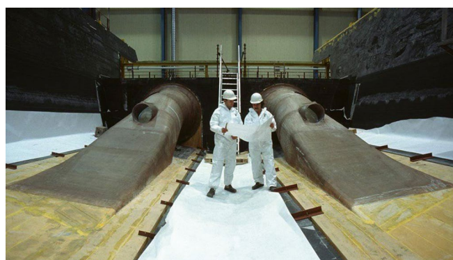
Рисунок 11. Водоводы водометов корвета класса Visby [5]
