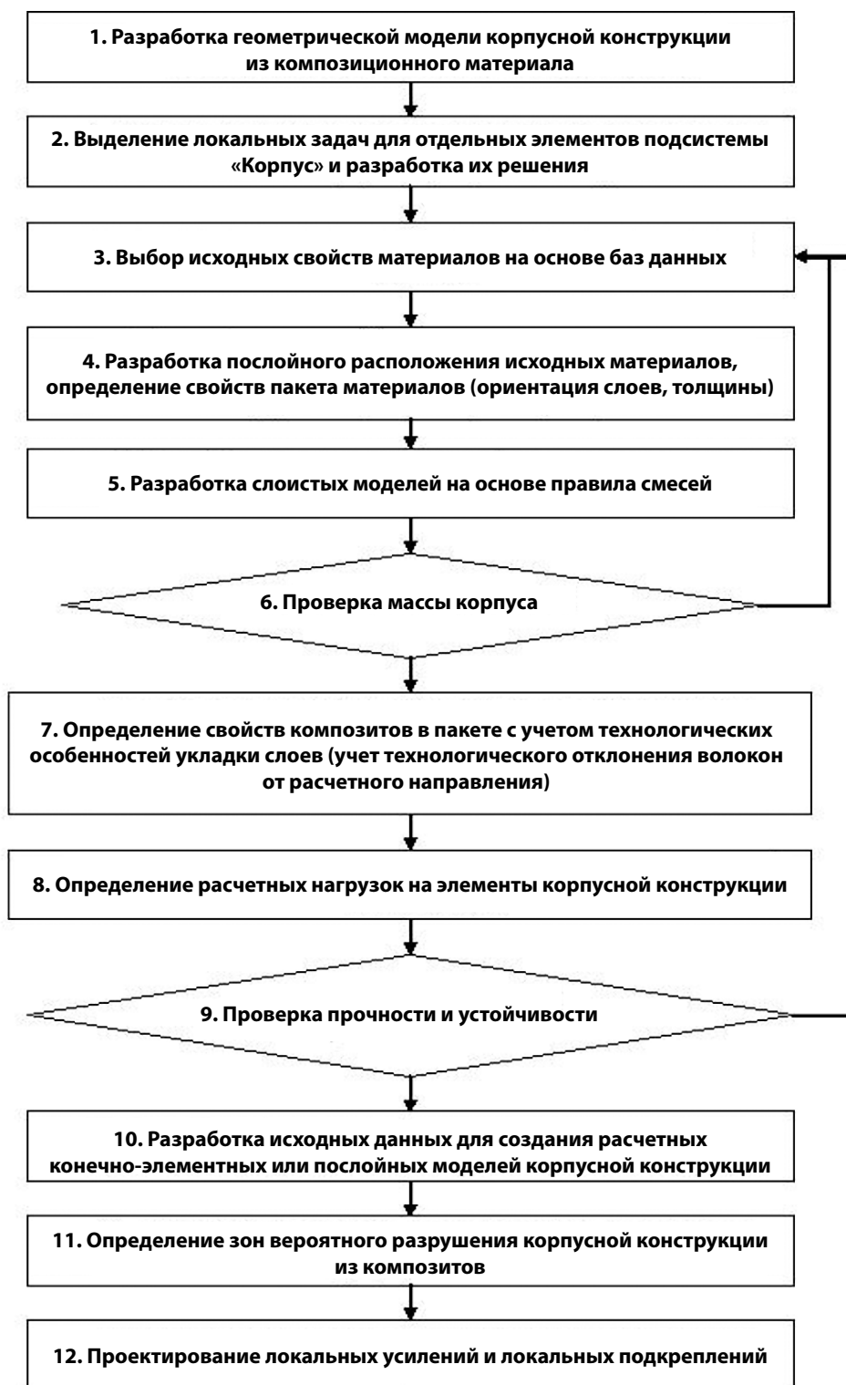
Рис. 2. Последовательность рассмотрения проектных обоснований при проектировании подсистемы «Корпус» судна из композиционных материалов
