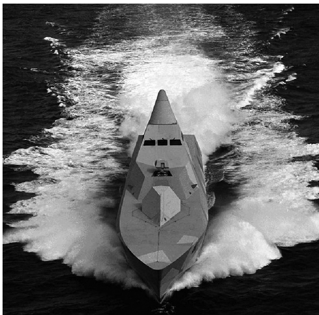
Однокорпусное судно специального назначения переходного режима движения, полностью из композиционных материалов
