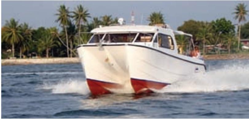
02 Пассажирский глиссирующий катамаран (Таиланд), корпус которого полностью выполнен из композиционных материалов. Отличительная особенность – носовое расположение рубки и наличие продольных реданов.
