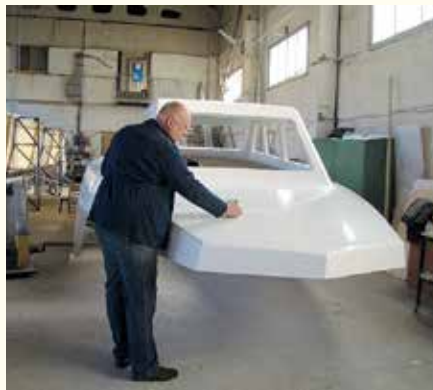
Рис. 10. Дефектоскопия надстройки СПК из композитов
